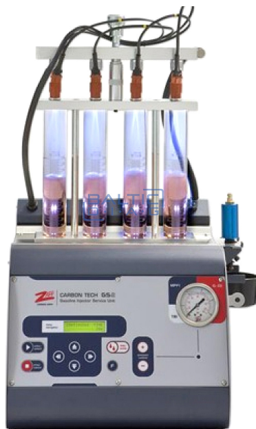
2 pav. Benzininių purkštukų testavimo stendas su ultragarsiniu valdymu GS2
